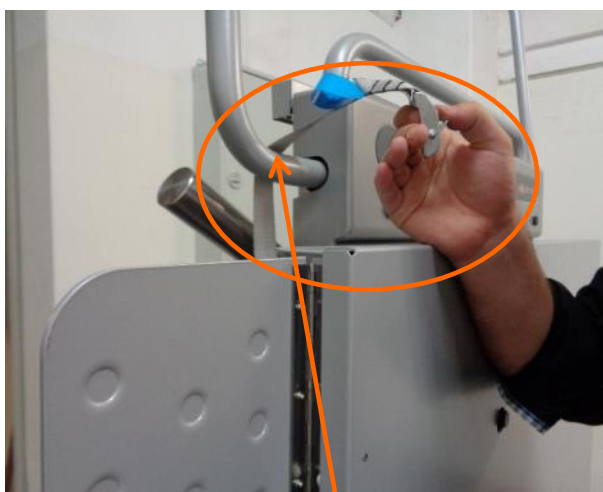
Ujistěte se, že je napínací pás veden nahoře přes bezpečnostní bariéru .
